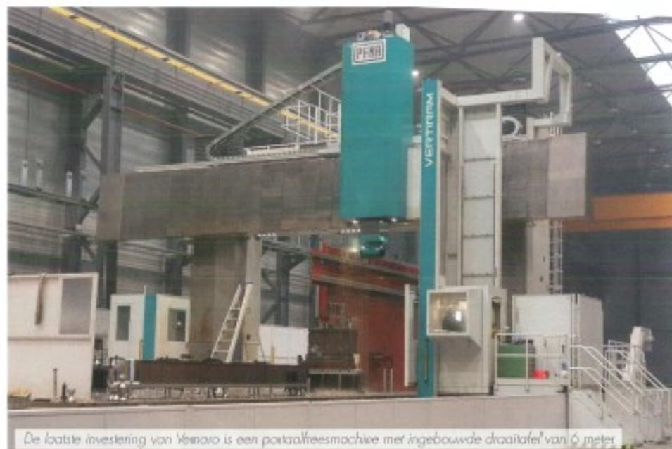
De laatste investering van Vemaro is een portaalreesmachine met ingebouwde draaitafel van 6 meter.
