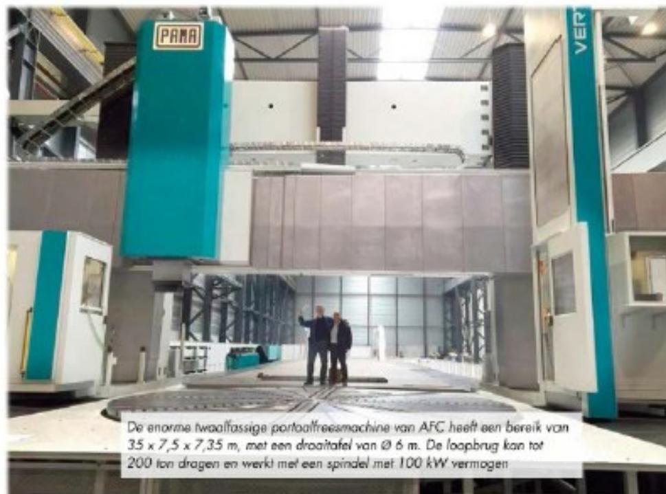
De enorme twaalfassige portaalreesmachine van AFC heeft een bereik van 35 x 7,5 x 7,35 m, met een draaitafel van Ø 6 m. De loopbrug kan tot 200 ton dragen en werkt met een spindel met 100 kW vermogen
